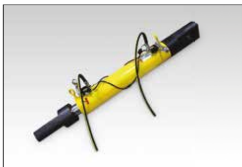
◀ Cylindry podwójnego działania ze sterowanymi za pomocą pilota zaworami zwrotnymi i okrągłymi uchami na obu końcach do podnoszenia i ustawiania.
