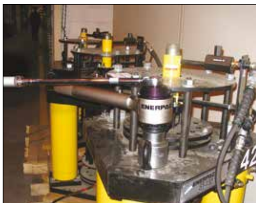
◀ Wzmacniacz momentu obrotowego z prętem reakcyjnym typu Enerpac E393 stosowany do śrub momentowych ręcznych do 4300 Nm.
