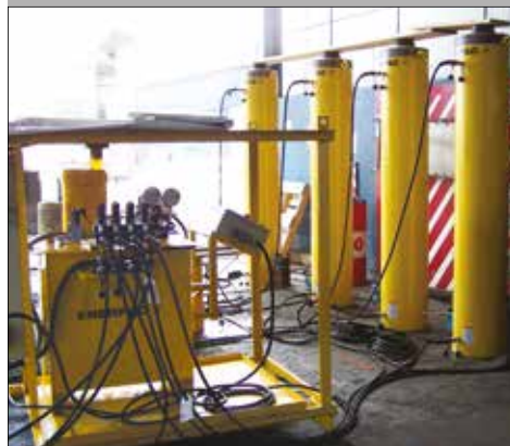
▲ Wykonane na zamówienie cylindry dwustronnego działania o udźwigu 500 ton i skoku 1,83 m do podnoszenia elektrycznych koparek linowych.
