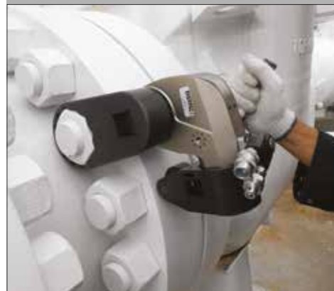
▲ Niestandardowy klucz dynamometryczny S11000X z niestandardowym łącznikiem i walcem reakcyjnym.
