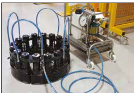
◀ System napinania do układów wielośrubowych (MST) firmy Enerpac umożliwiające jednoczesne napinanie wszystkich śrub dwustronnych w połączeniu.
